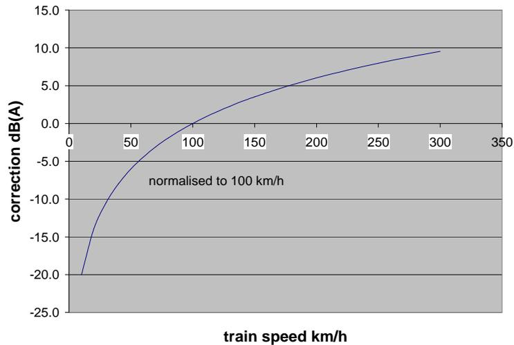
**Figure 6 : Rolling Noise Speed Correction**
