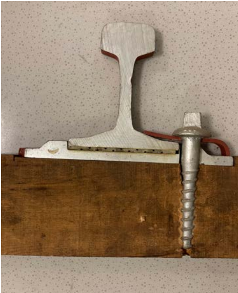
Cross-section of a track on a sleeper – Coupe d'une voie sur traverse
