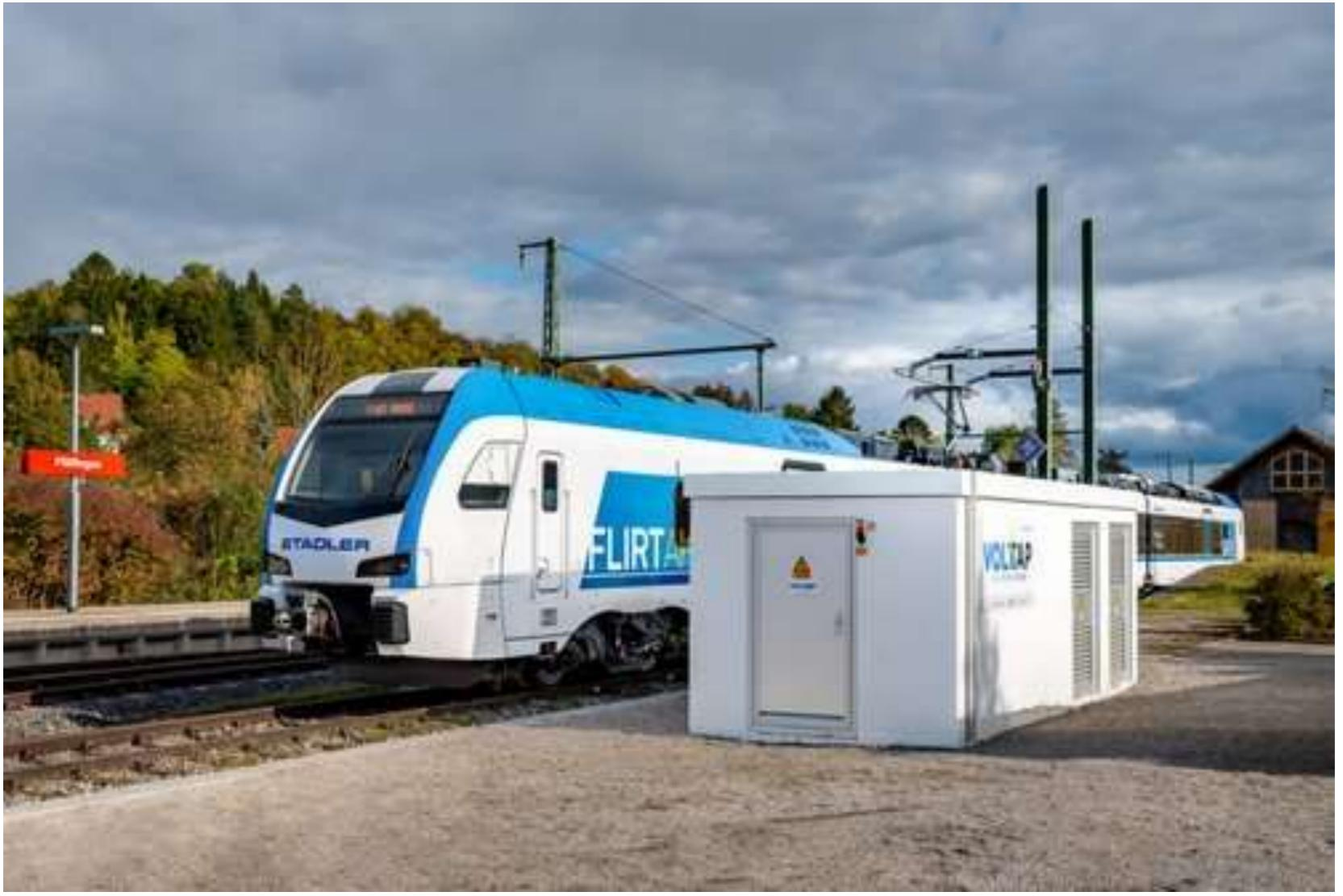
VOLTTAP – RAIL POWER CHARGER – weltweit erste Schnellladestation für Batteriezüge (BEMU) - Stadtwerke Tübingen
