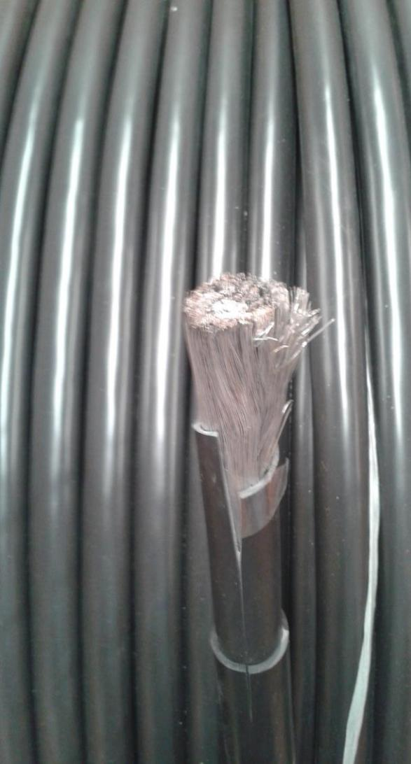
El cable original, del tipo unipolar, posee una sección de  $185 \text{ mm}^2$  (*sección eléctrica*). El nuevo tiene una sección de  $240 \text{ mm}^2$  (*sección total*).
